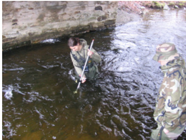
Figure 3. Mesure de la vitesse de l'eau à l'aide d'un vélocimètre
