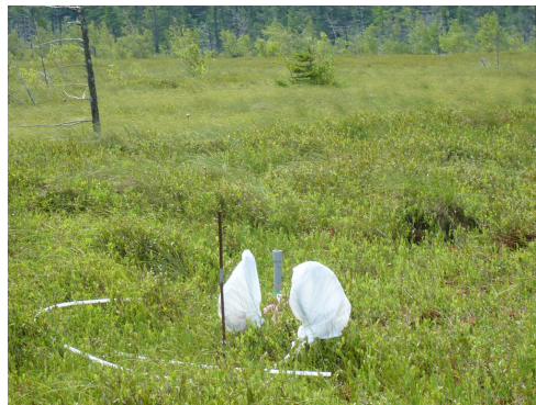
Figure 6. Exemple d'une grappe de piézomètres dans la tourbe
