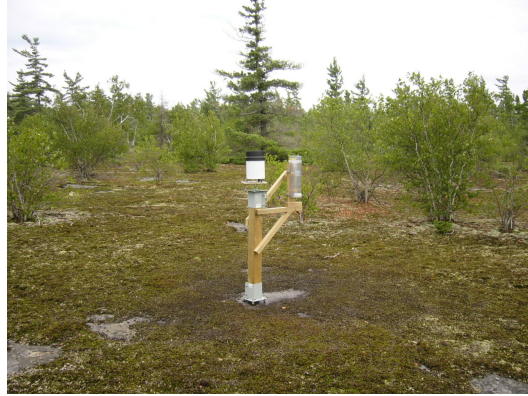
Figure 8. Pluviomètres automatique et manuel
